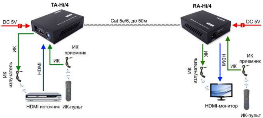
Рис. 8 Схема подключения TA-Hi/4 + RA-Hi/4
