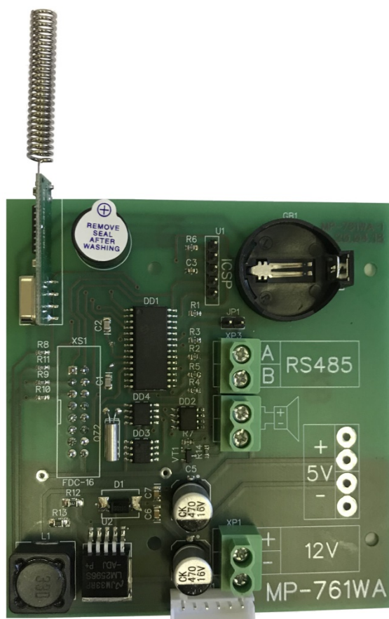
Рисунок 4.1. Внешний вид платы управления табло MP-761WA
