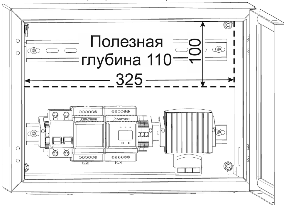
Рисунок 1 – Пространство внутри для установки доп. оборудования
