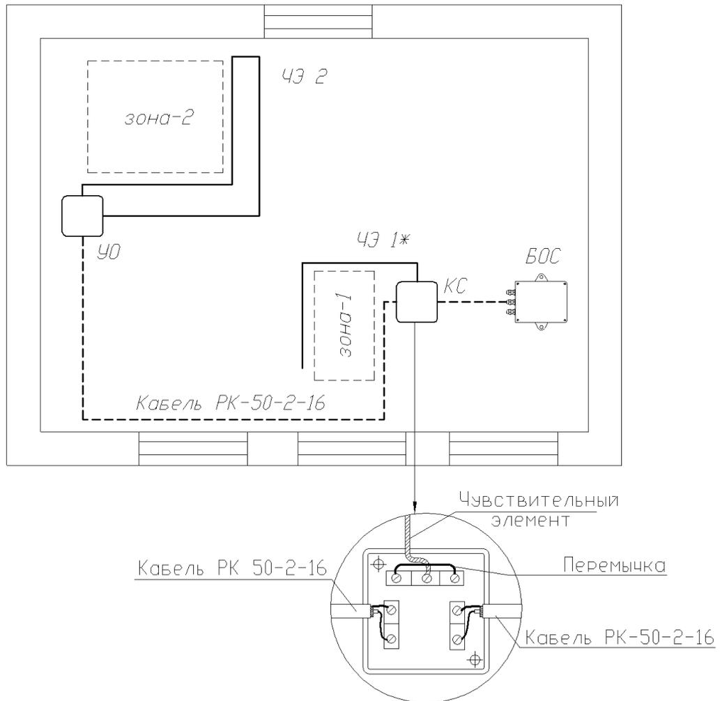
БОС – блок обработки сигналов извещателя "Гюрза-027ПЗ"
