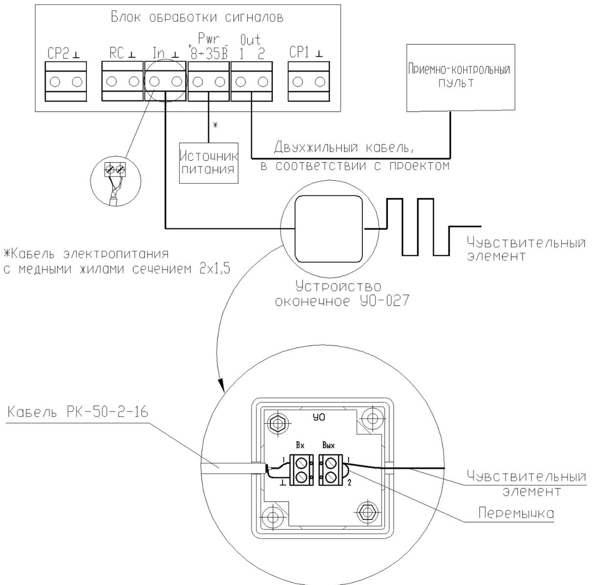
*Данный вариант обеспечивает контроль целостности только линии подключения чувствительного элемента и не обеспечивает контроль целостности самого чувствительного элемента.*
