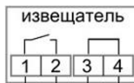
Рисунок 2в. Схема подключения ИО102-51(НР+Пр)
