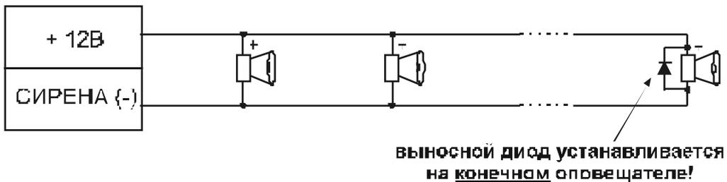
Рис. 6.2. Схема подключения нескольких звуковых оповещателей
