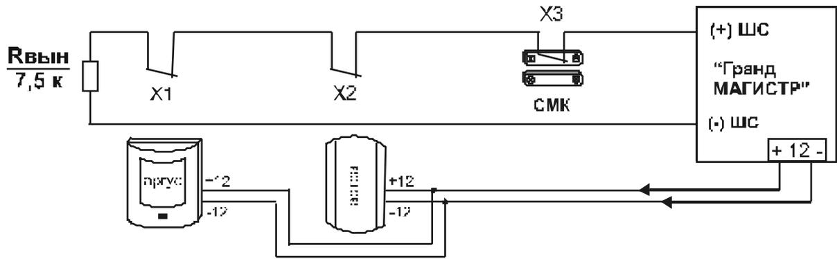
Рис. 5. Схема подключения ШС с охранными извещателями
