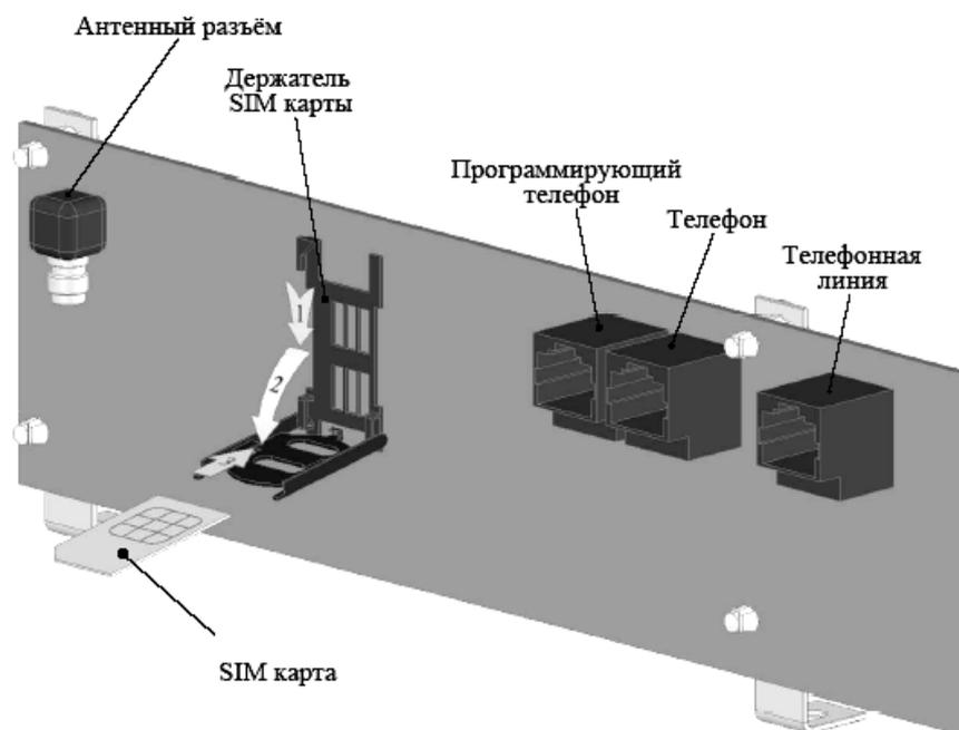
Рис. 1. Внешний вид модуля.
