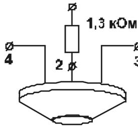
**Схема подключения дымовых и комбинированных
