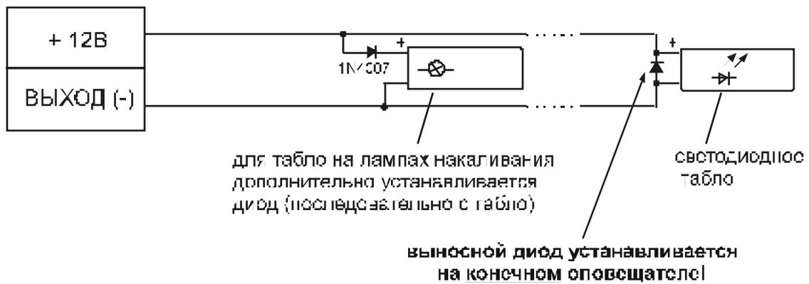
Рис. 6.1. Схема подключения нескольких световых табло
