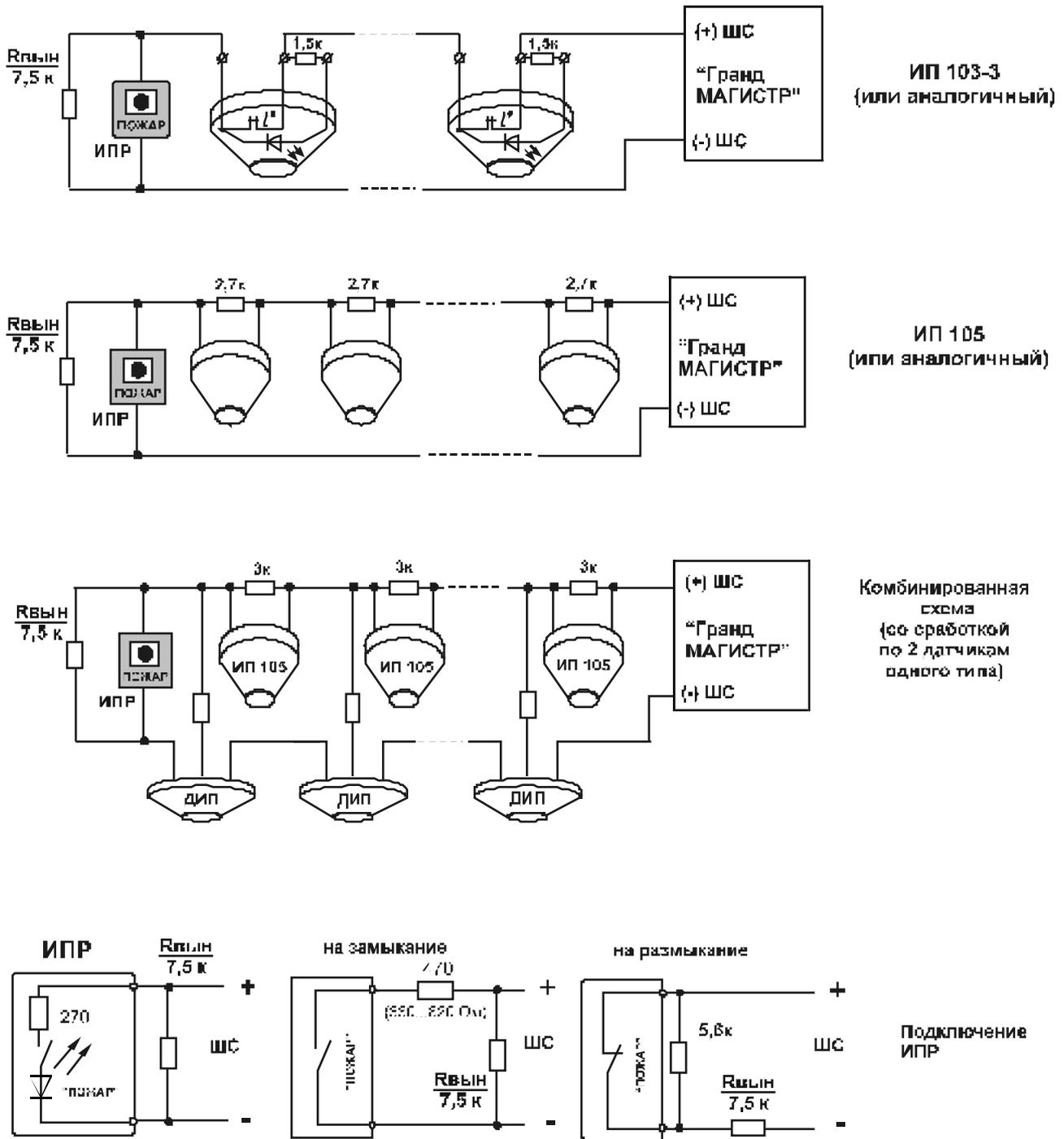
Рис. 4.2. Организация двухпорогового шлейфа пожарной сигнализации
