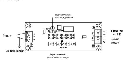
Настройка приемника RX на линию по изображению на мониторе.
