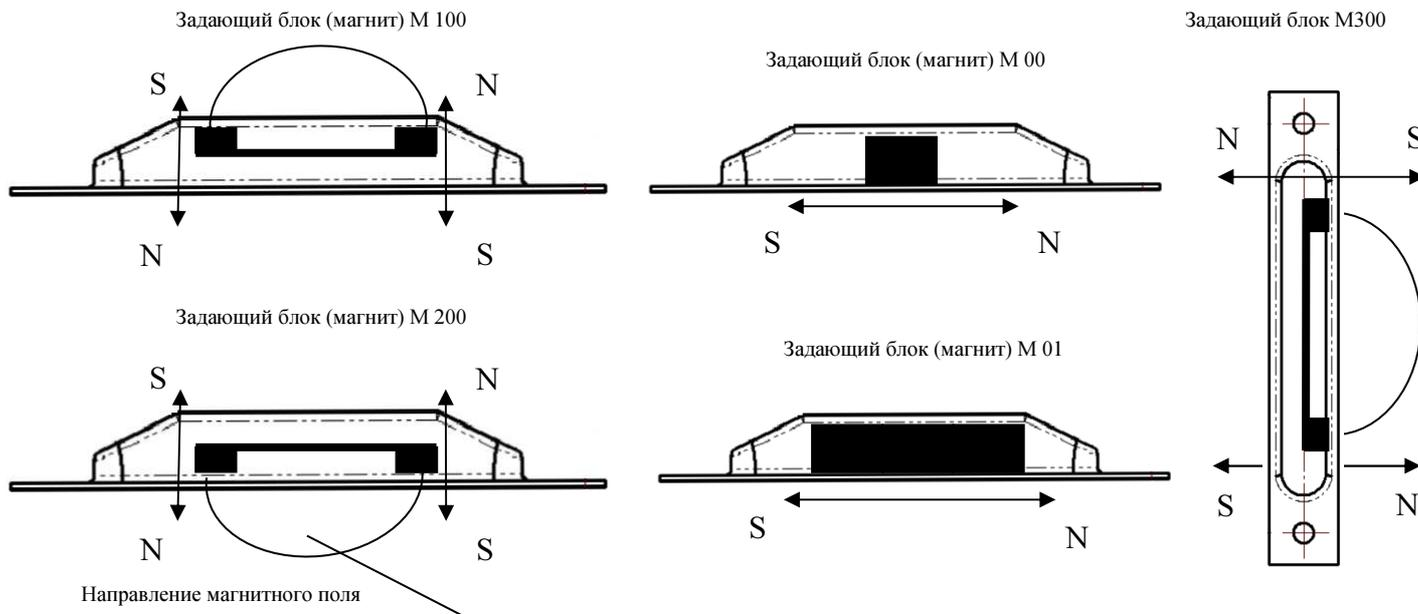
Рисунок 3 – Отличительные конструктивные особенности различных модификаций задающих блоков
