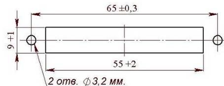
Рисунок 1 – Разметка для крепления
