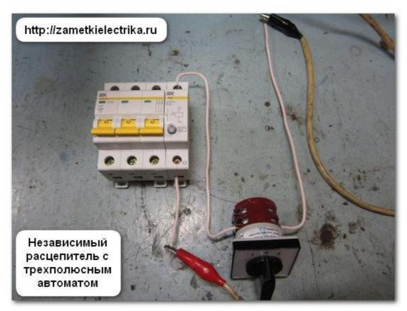
И здесь все аналогично. При повороте ключа управления (замыкании контакта) независимый расцепитель срабатывает, тем самым отключая автоматический выключатель.
