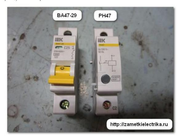
Как и расцепитель максимального и минимального напряжения РММ47, расцепитель РН47 стыкуется с автоматом с его правой стороны. При этом автомат в обязательном порядке должен быть в отключенном положении, а кнопка «Возврат» («Reset») расцепителя нажата.
