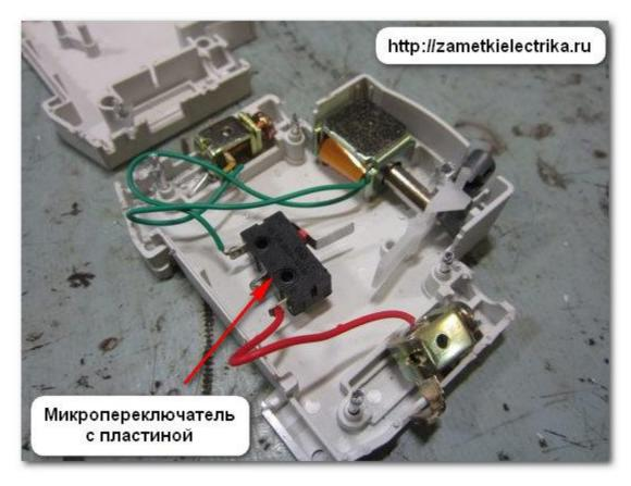
При срабатывании катушки расцепителя кнопка «Возврат» отскакивает и своим штоком размыкает контакт встроенного микропереключателя, установленного внутри корпуса расцепителя.
