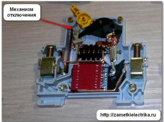
Расцепитель вставляется в автоматический выключатель до упора — никаких фиксаторов нет.
