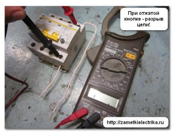
В общем, электрическая схема независимого расцепителя очень проста — это катушка, включенная через контакт микропереключателя, и две клеммы для подключения расцепителя к источнику переменного напряжения.
