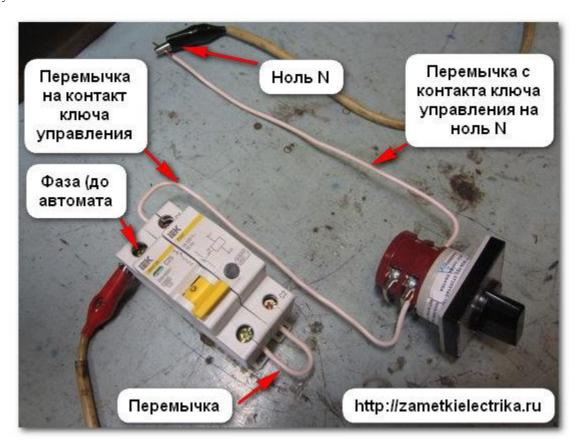
При повороте ключа управления (замыкании его контакта) независимый расцепитель срабатывает и отключает автоматический выключатель. На лицевой стороне расцепителя выскочила кнопка «Возврат» («Reset»), что символизирует о том, что автомат отключился по причине воздействия на него независимого расцепителя.
