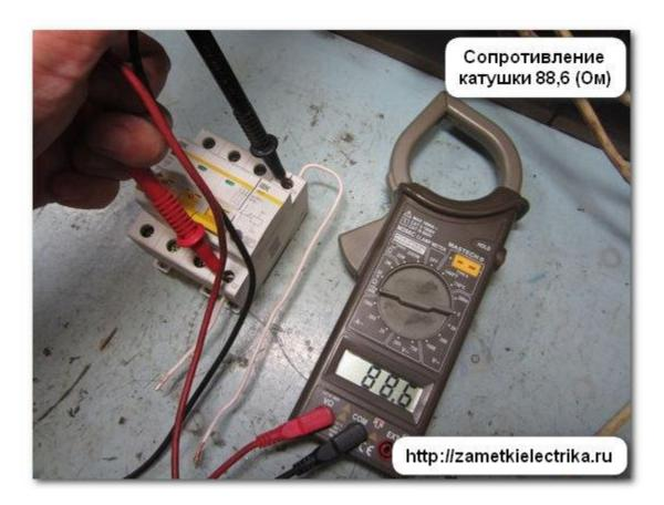
А вот при отжатой кнопке сопротивление катушки уже измерить не получится, т.к. ее цепь разомкнута контактом микропереключателя.
