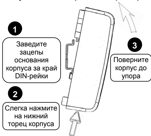
Рисунок 3. Крепление контроллера на DIN-рейку
