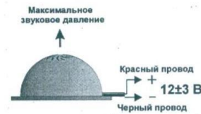
Рис.2 Схема подключения и диаграмма направленности оповещателя ПКИ-1.
