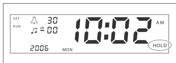
рисунок 6.3: Блокировка органов управления передней панели
