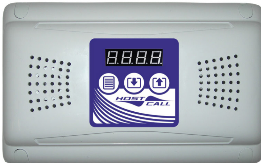
Рисунок 2. Внешний вид системного контроллера MP-231W2
