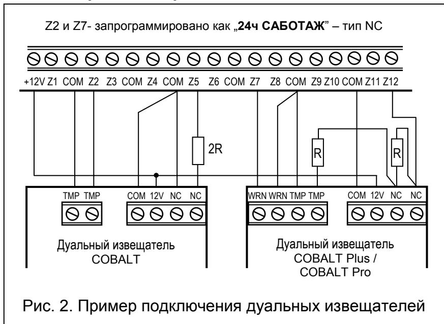
Рис. 2. Пример подключения дуальных извещателей
