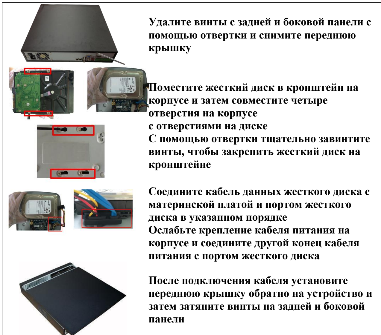
Рисунок 5.1 Порядок установки жесткого диска.
