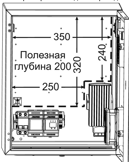
Рисунок 1 – Пространство внутри для установки доп. оборудования
